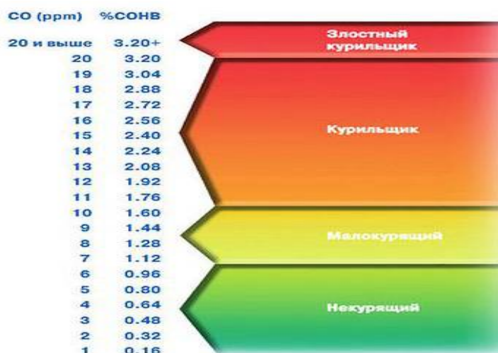
Рис. 4. Наглядная демонстрация показателей CO во выдыхаемом воздухе на газоанализаторе с определением карбоксигемоглобина
